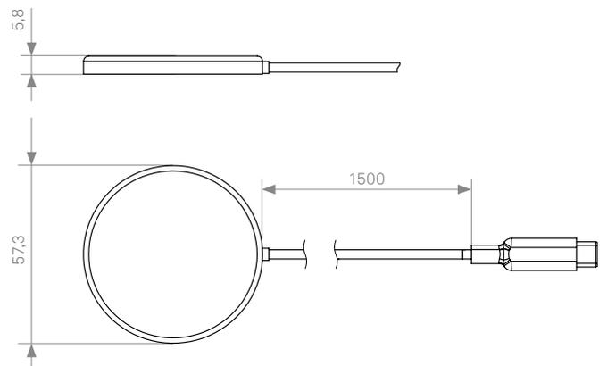
Un transformateur d'alimentation séparé avec une connexion USB-C est nécessaire pour la fonction.
